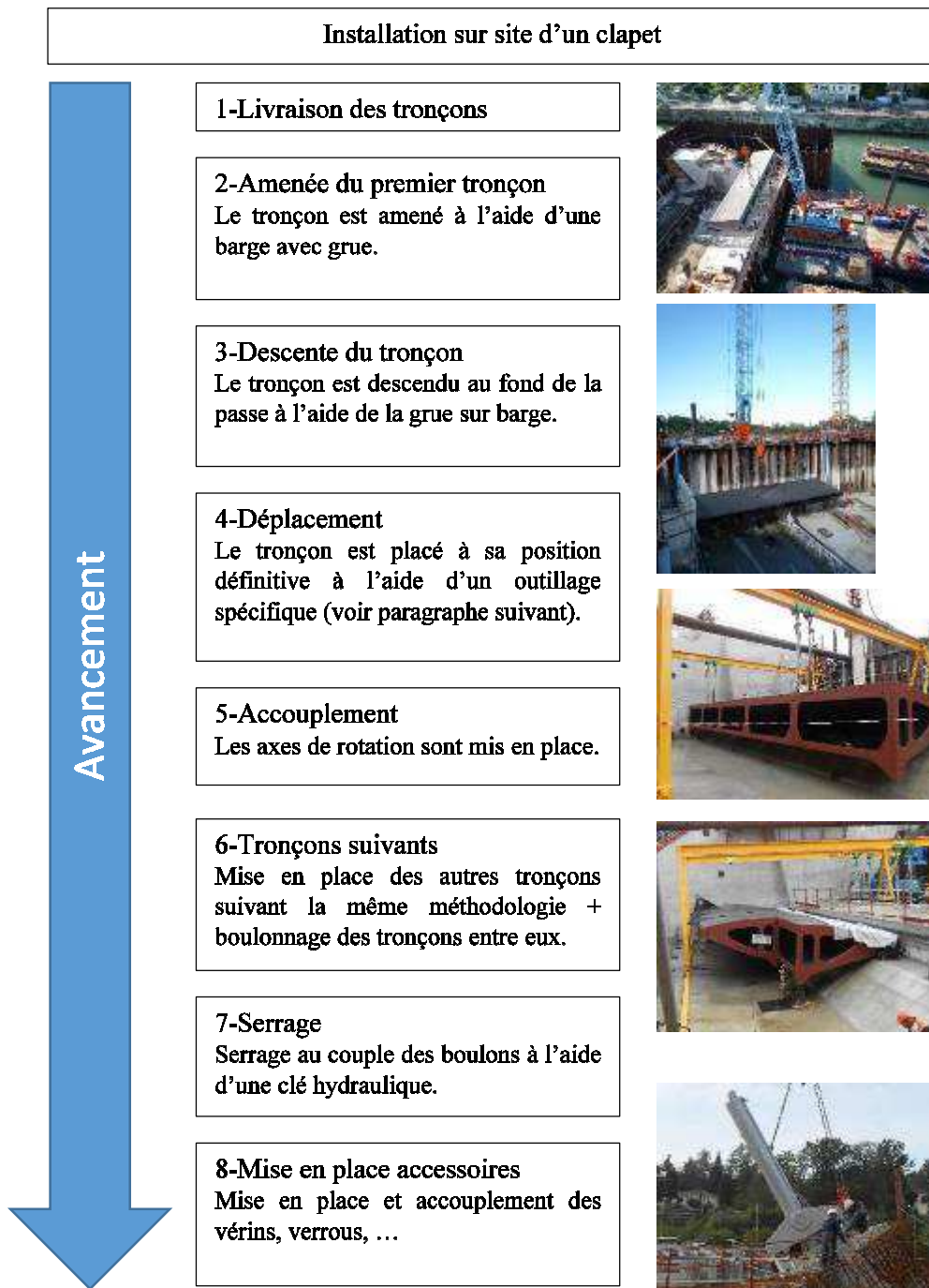
Figure 11 : Processus de pose sur site
