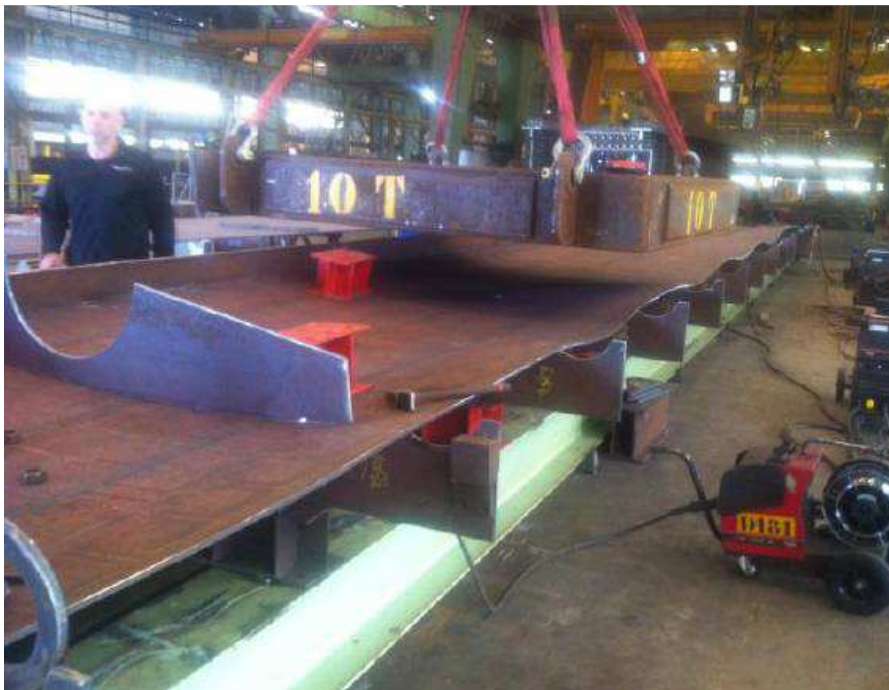
Figure 7 : Vue du problème d'ondulation constaté sur le tôle du premier clapet lors de la fabrication
