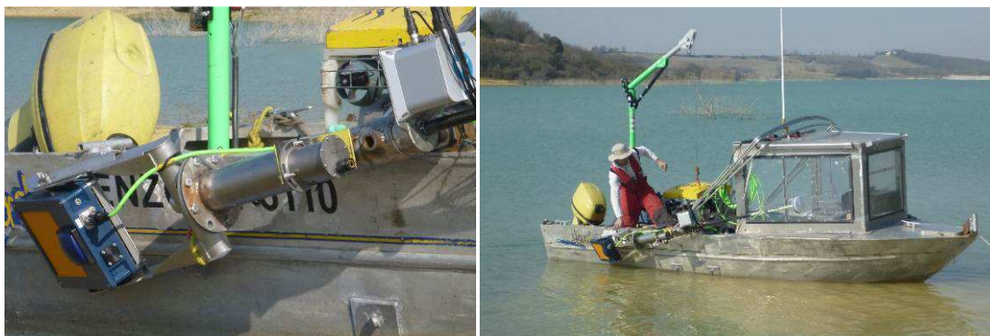
Image 19: Caméra acoustique 3D portée sur embarcation
