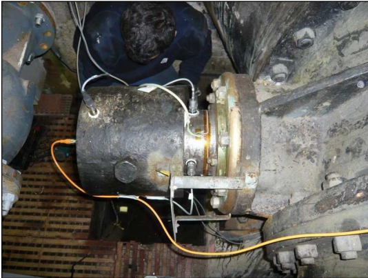
Figure 5.a : Instrumentation de l'arbre
