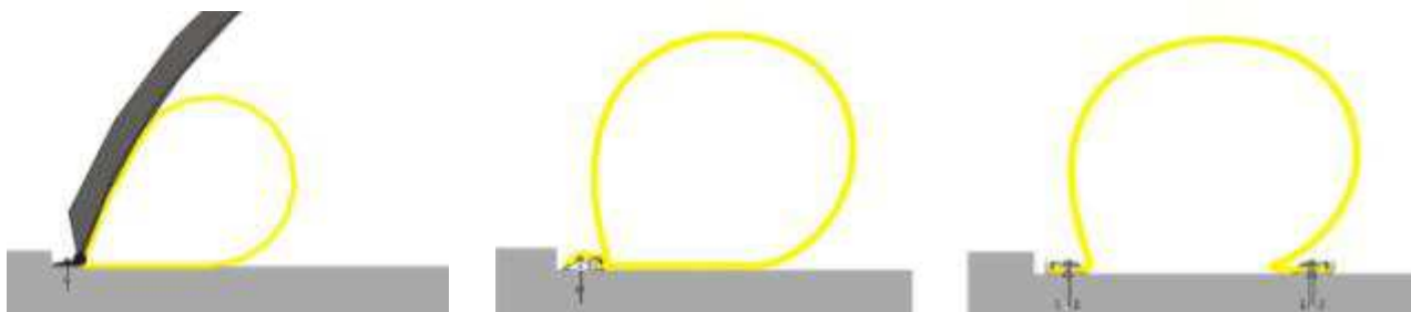
Figure 3 : coupes types des différentes technologies de bouchures [crédit image ©BRLingénierie]
