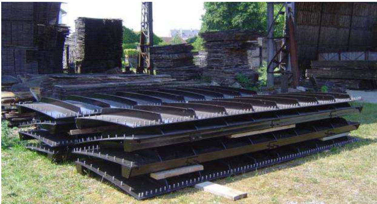
Figure 13 : stock de volets métalliques équipés de poutres de renfort [crédit image © J.Aubonnet]
