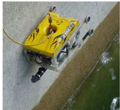
Image 17 : Scanner 2D porté sur ROV
