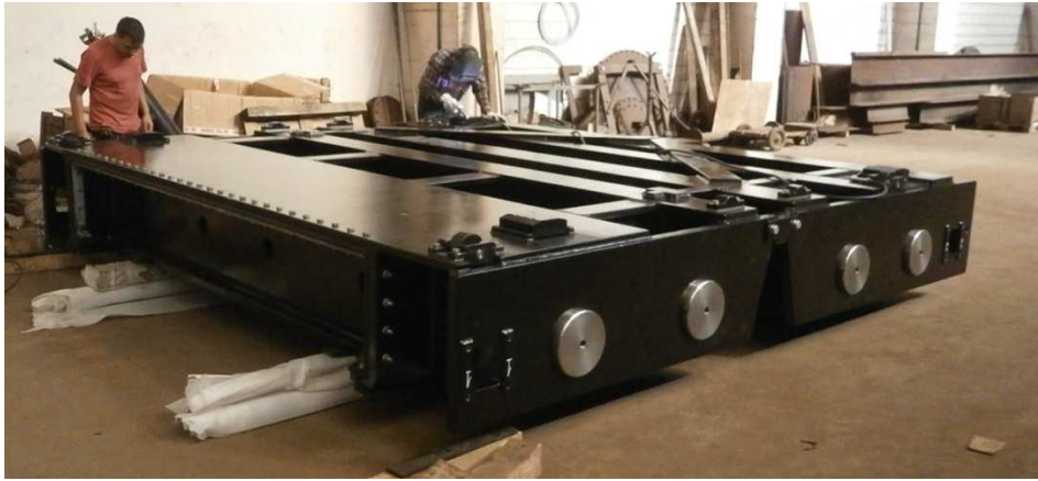
Graphique 6: Fin de montage d'une vanne en atelier
