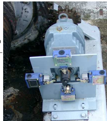
Montage à 4 détecteurs : croquis (à gauche) ; installation sur treuil (en cours de montage, à droite)
