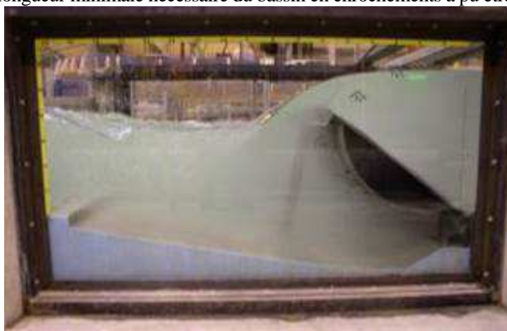
Figure 15: Visualisation de la lame d'eau et du jet plongeant
