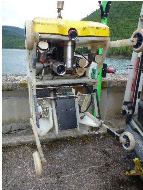
Image 5 : caméra acoustique 2D montée sur ROV
