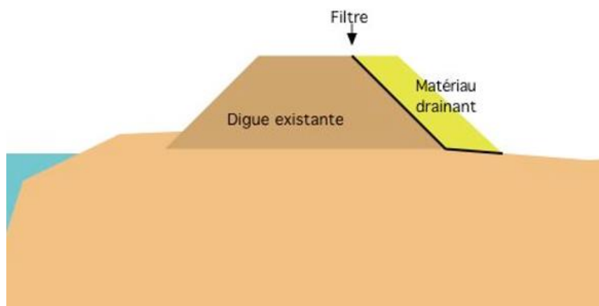
Figure 4.10 : Recharge drainante et filtre (schéma : R. Tourment)
