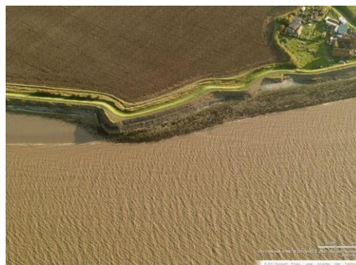
Figure 8.10 : Schéma et photographie illustrant la transition entre deux tronçons de digues de conception différentes [8-1]
