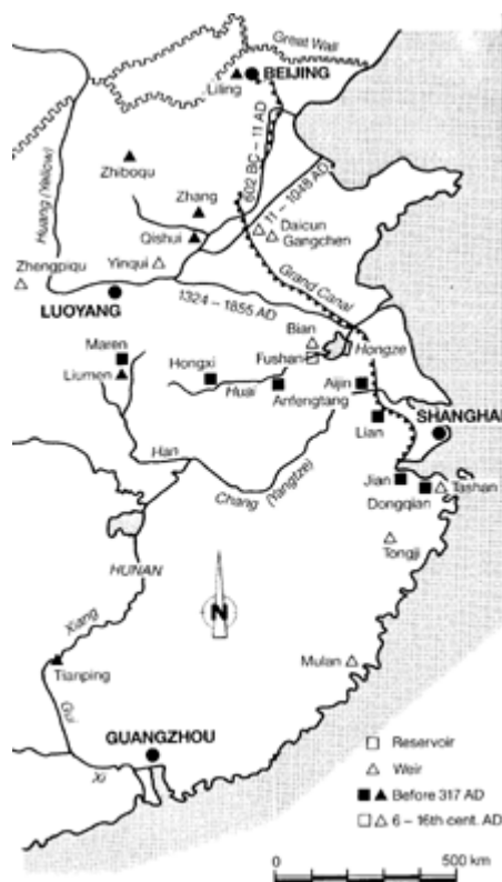
Figure 7 : Carte de la Chine orientale reproduisant quelques grands travaux hydrauliques du 1er millénaire jusqu'au XVIème siècle (cité par Schnitter)
