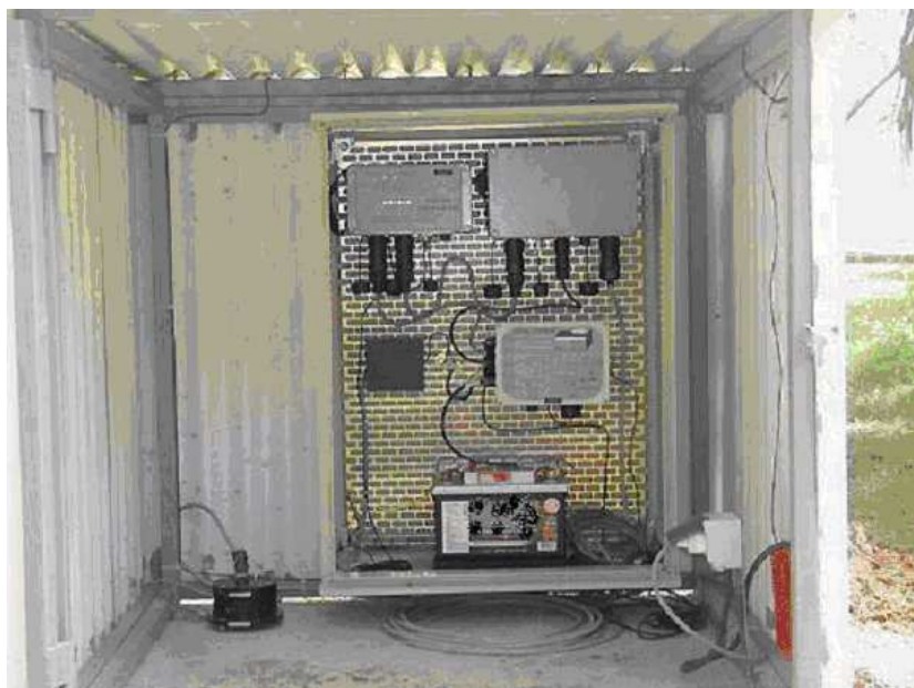
Figure 2-14 – Exemple de station sismique – le capteur est au sol à gauche et la station d'acquisition à droite (source IPGP)
