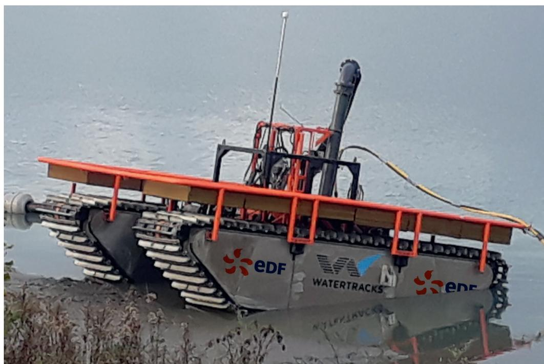
Les opérations de dragage peuvent avoir de fortes contraintes techniques et environnementales ; EDF a développé, en partenariat avec Watertracks, un robot de dragage autonome NESSIE® permettant de réduire les nuisances au maximum et qui sera utilisé sur la retenue du Chambon avec turbinage des eaux chargées et rejet dans la Romanche (figure 4.2).
