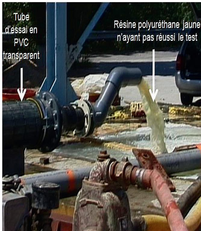
Devant cette situation, et la complexité des résines polyuréthanes, à partir de 1997 le laboratoire de EDF-TEGG à Aix-en-Provence a procédé à deux séries de tests de résines présentes sur le marché, en particulier les résines polyuréthanes mono-composant et bi-composants.
