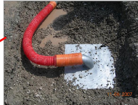
Plaque métallique, le capteur de pression est situé au-dessous de cette plaque dans un coffret
