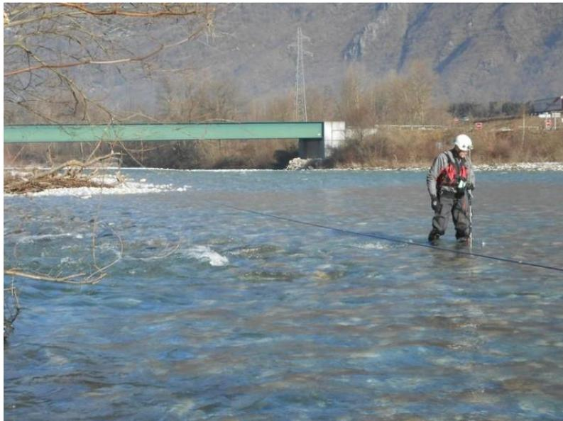
**Figure 6 :** Le site du Pont Saint Thomas (P1). Réalisation de mesures de hauteurs et de vitesses pour déterminer les conditions de repli depuis l'îlot principal vers la rive gauche au débit d'alerte ( $16 \text{ m}^3/\text{s}$ ).
