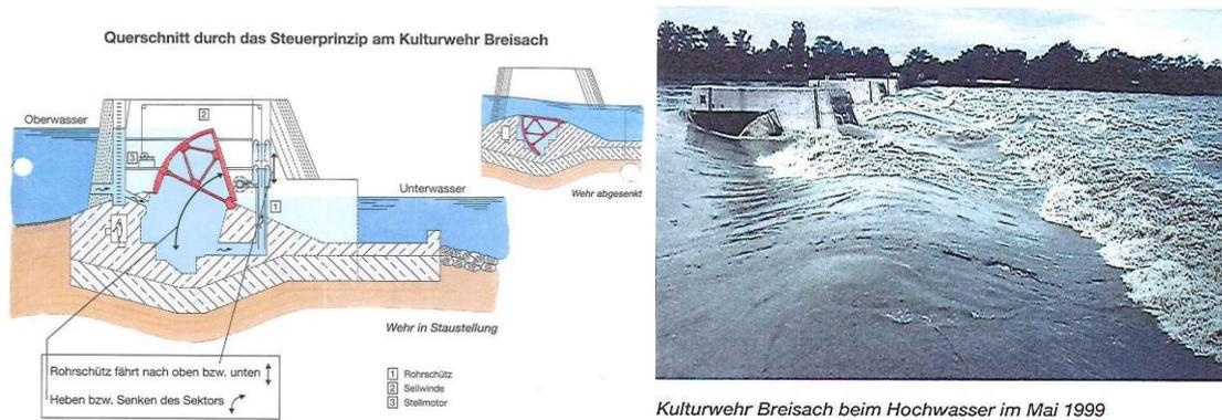
**Figure 3 :** Coupe et photographie en position vannes effacées du barrage agricole de Breisach. Marckolsheim : vannes wagon superposées permettant un débit au-dessus ou en-dessous des demi-vannes :
