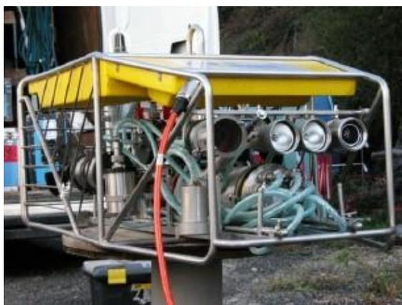
**Graphique 2 :** ROV utilisé pour l'inspection des parements amont des barrages SPW
