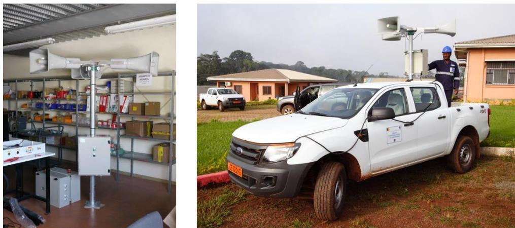
**Figure 19:** prémontage des sirènes en atelier AE&T (à gauche) et mise en service d'une sirène sur véhicule 4x4 au barrage (à droite) (photos © AE&T et ISL ingénierie)
