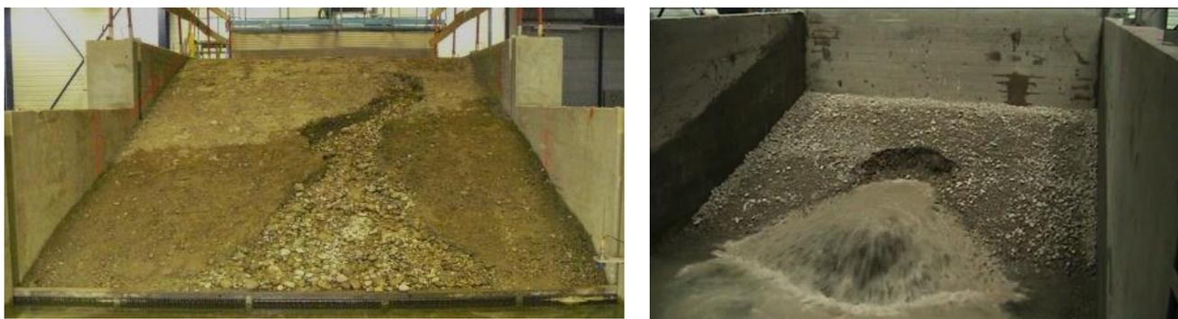
**Graphique 6 :** Recharge suffusive avec déchaussement régressif (gauche) et recharge perméable et non suffusive claquée (droite)
