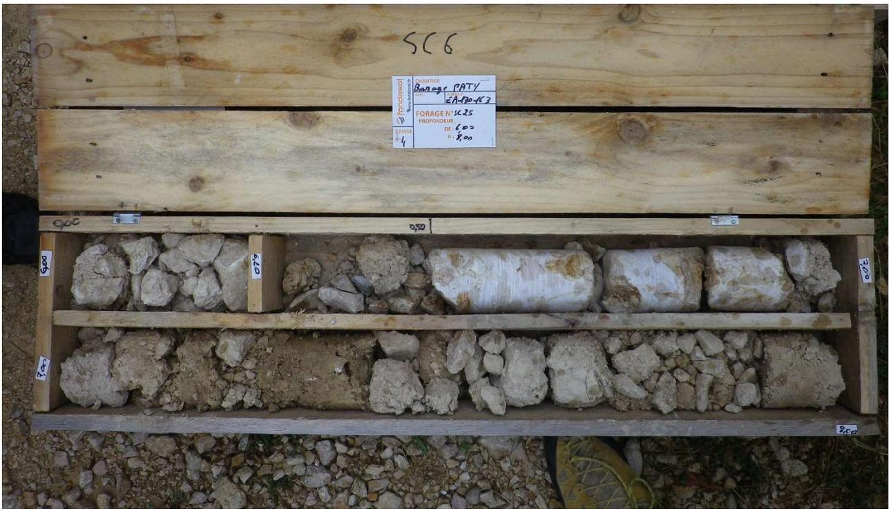
**Figure 3 :** Le taux de récupération des carottes est de l'ordre de 80%. La granulométrie du matériau rend très difficile la récupération d'échantillon intact. Lorsque les enrochements (5-15cm) sont présents, les fluides du forage entraînent l'intégralité des matériaux fins. Localement, il a été possible d'avancer par battage lorsque les enrochements étaient absents.
