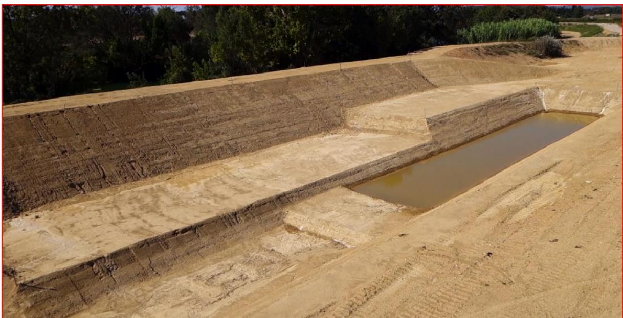
**Graphique 11 :** La digue expérimentale : section non traitée à gauche et section traitée à droite
