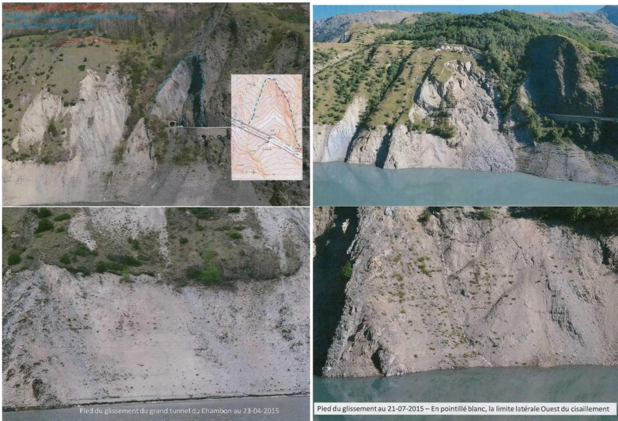
**Figure 6 :** Evolution du glissement du 23/04/2015 (à gauche) au 21/07/2015 (à droite) – vue globale (haut) et pied du glissement (bas)
