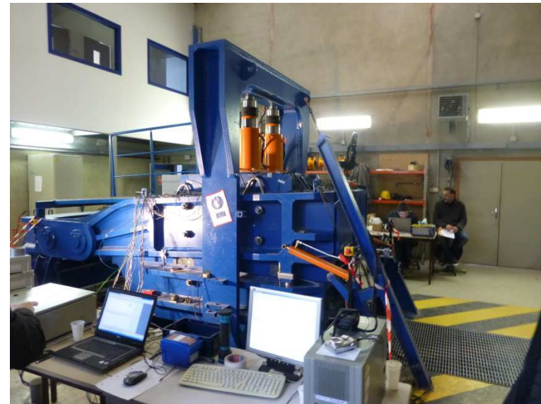
ESSAI à la grande boîte de cisaillement du CEREMA DTerCE
