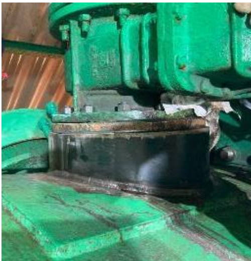
Figure 20-Résultat des soudures longitudinales et sur la selle non contraignantes
