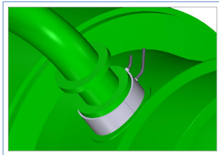
Figure 13- Vue d'implantation de la coque d'injection sur le piquage aval
