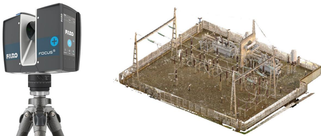
Figure 4: Scanner d'environnement (à gauche) / Nuage de points couleur d'un transformateur électrique (à droite)
