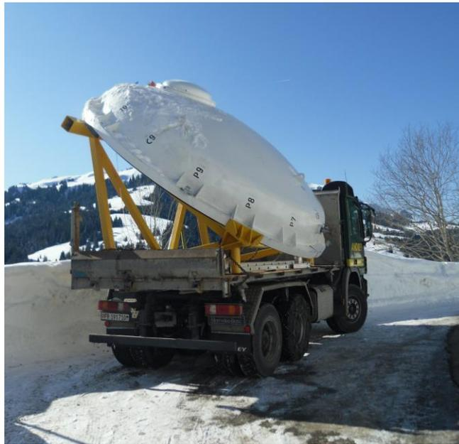
Figure 13 : Transport de l'obturateur circulaire sur un châssis adapté vers le barrage de l'Hongrin (Suisse)
