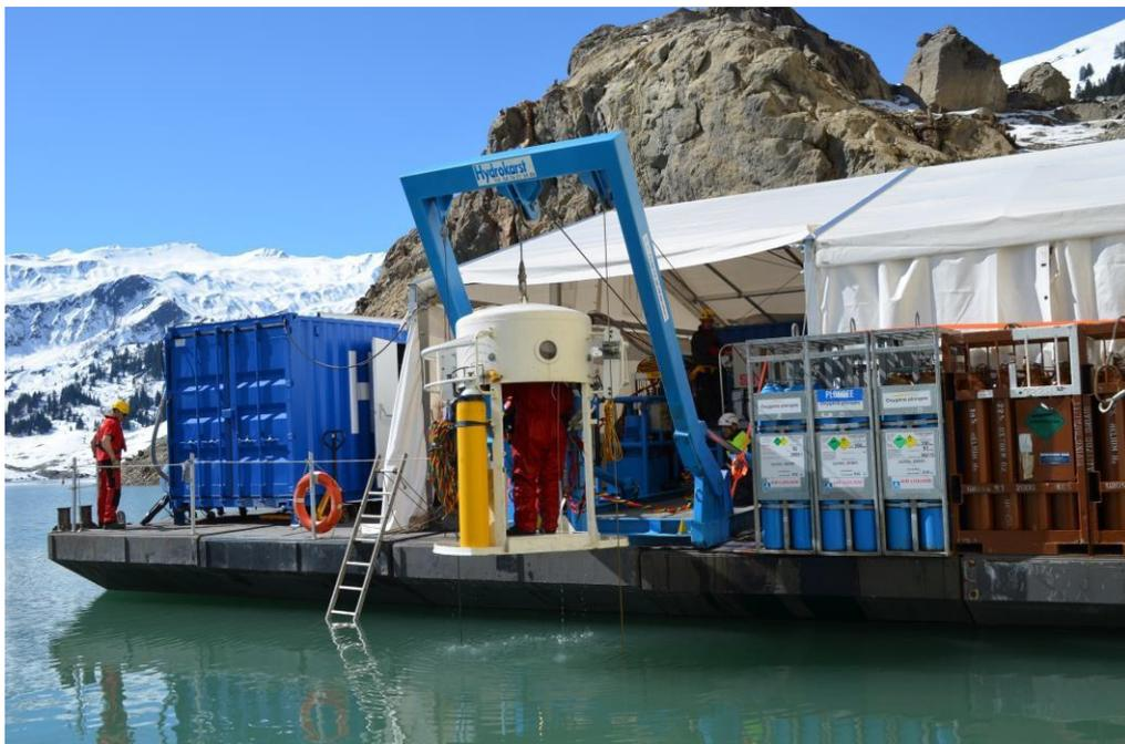
Figure 10 : Ponton entièrement équipé pour la plongée bulle (wet bell)
