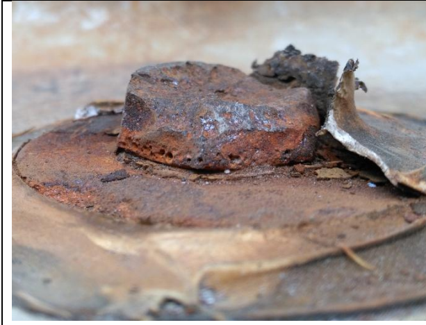
Figure 3 : tête de vis (1/3 de la matière est perdue)
