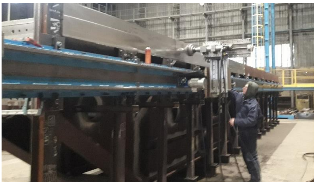
Figure 3 : dressage de la bride longue de 14,5m de l'élément n°3
