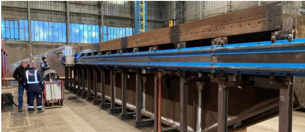
Photo 6 : dressage de la bride inférieure longue de 14,5 m de long de l'élément n°2; on voit le nombre important des supports verticaux du banc d'usage
