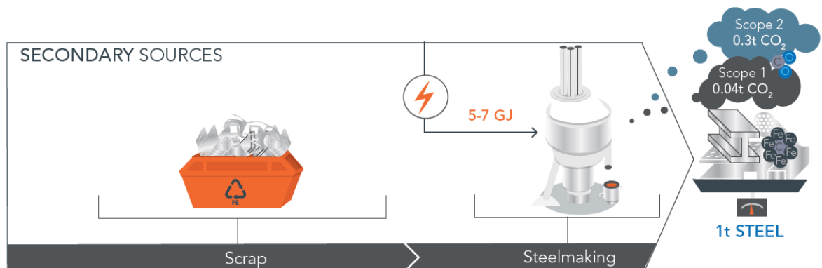
Figure 2 : filière d'élaboration d'acier par le four à arc électrique (EAF)
