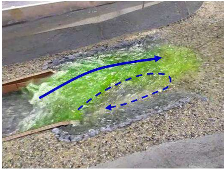
Graphique 6 : Ressaut asymétrique dans le bassin de dissipation – crue décennale
