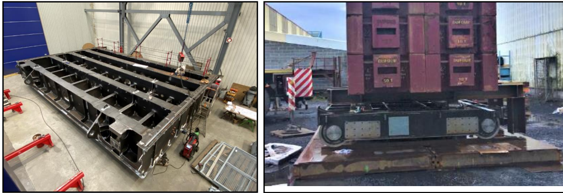
Figure 7 Montage à blanc porte - essais en charge chariot
