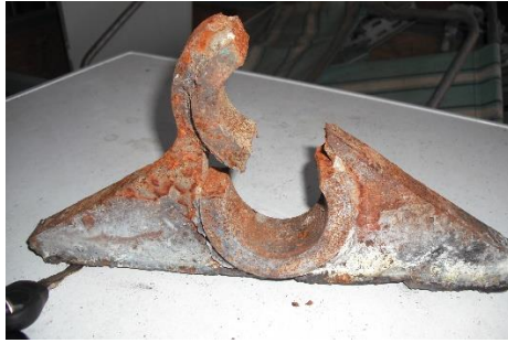
Figure 12 : Détail de la rupture de la pièce unique de liaison des câbles au clapet – mai 2010
