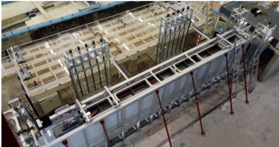
Figure 9 : Maquette au 1/25 de l'écluse d'Oisy – laboratoire du Service Public de Wallonie
