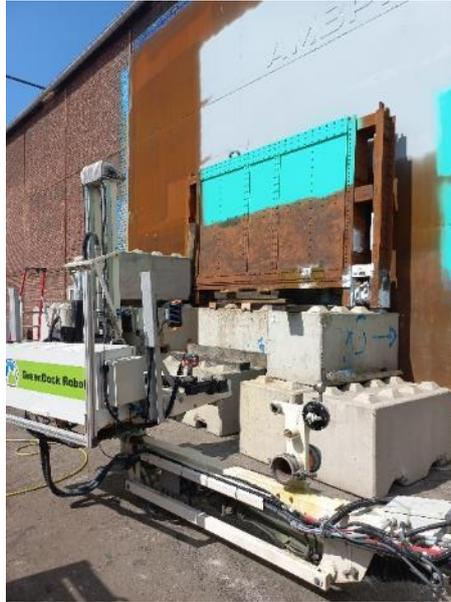
Figure 2 : photo d'un essai de décapage et de remise en peinture avec un robot AMBPR
