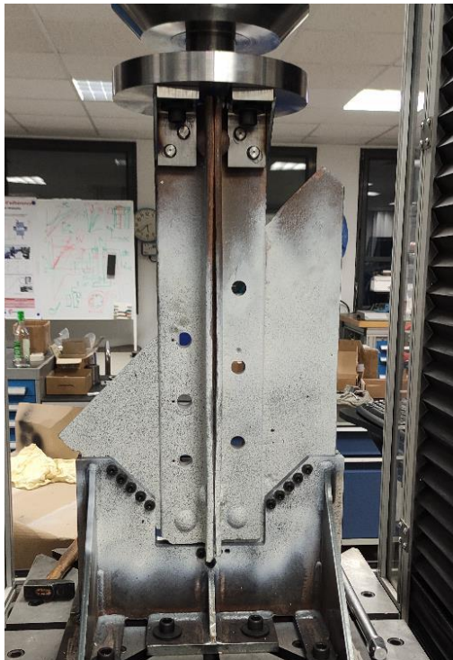
Photo 9 : Echantillon 2 rivets double cisaillement
