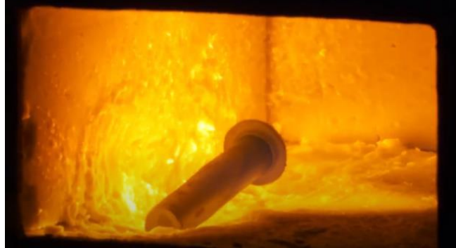
Photo 1 : Chauffage à 950°C au rouge cerise. Prise du rivet avec une pince. Taper le rivet au sol pour retirer la couche d'oxyde ou calamine.
