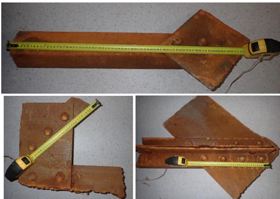
Photo 5 : Echantillons vanne 2 assemblages simple cisaillement ; 1 assemblage double cisaillement
