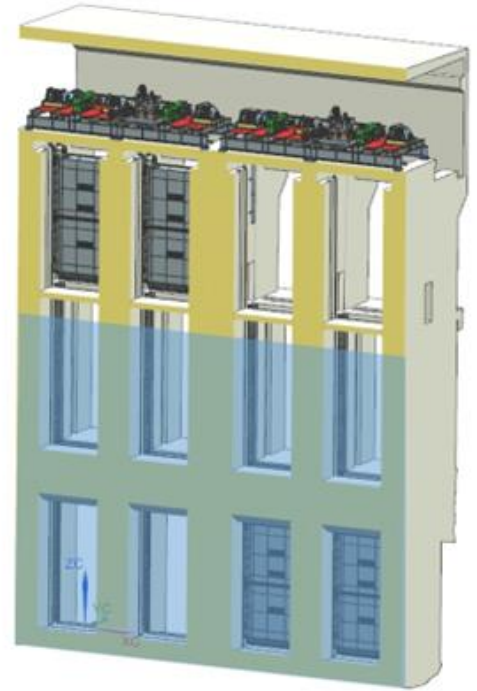
Figure 12 - Vue d'amont d'un ensemble de 4 vannes turbine d'un groupe
