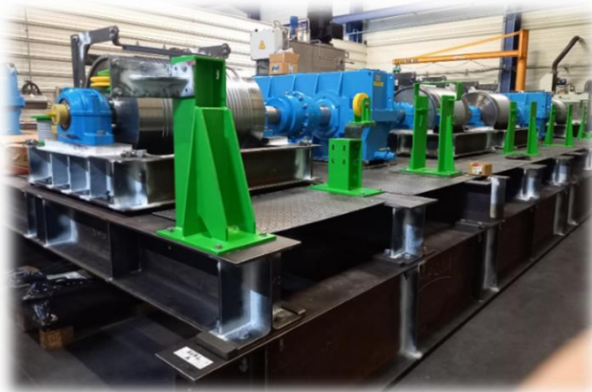
Figure 9 - Assemblage en atelier d'un treuil double
