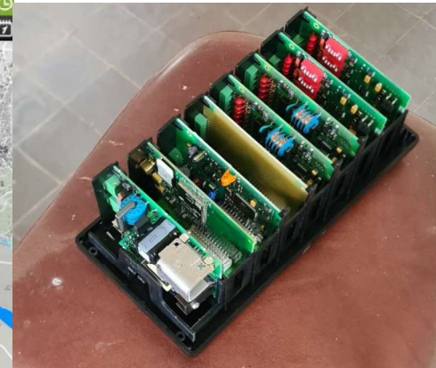
Centrale d'acquisition (SOFREL)
