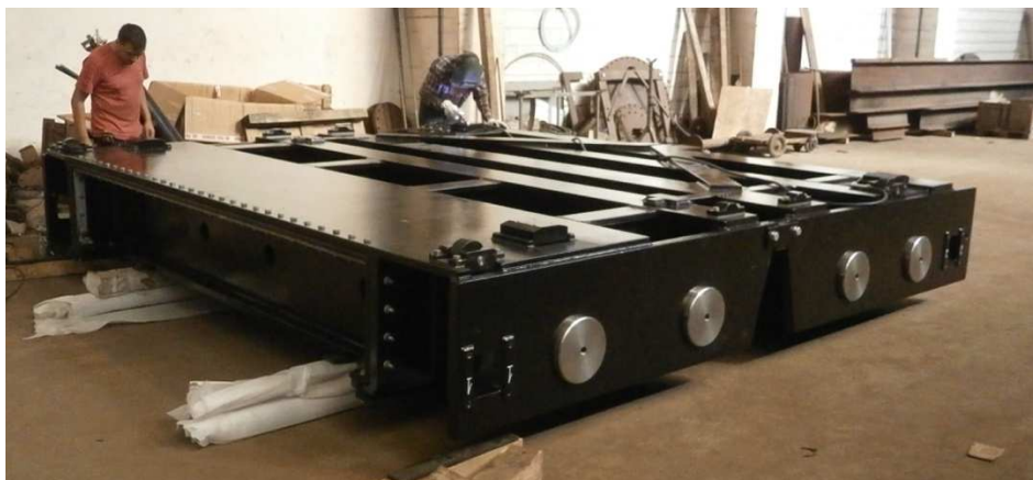
Graphique 6: Fin de montage d'une vanne en atelier
