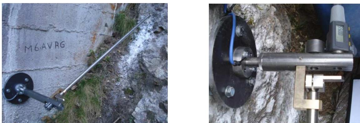
Figure 6 : Mesure de déplacement massif/rocher à Nentilla
