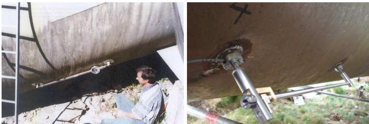
Figure 5 : Canne invar et extensomètre de parement modifié sur CF
