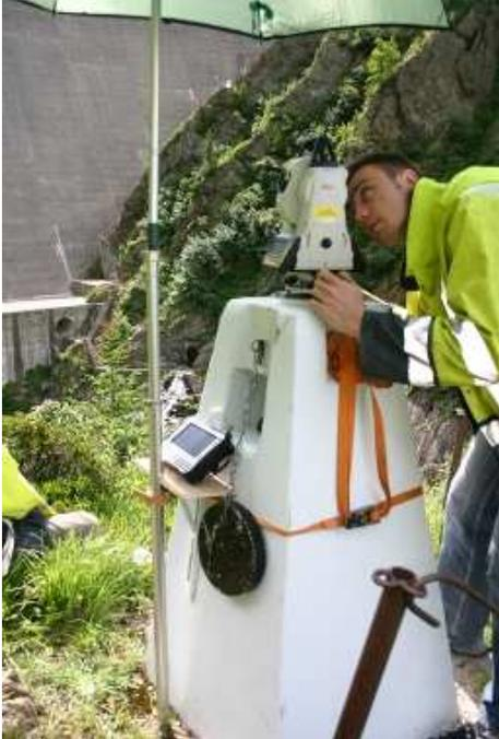
*Figure 1 : Auscultation du barrage de la Gittaz, Hyp-Arc [2009]*
