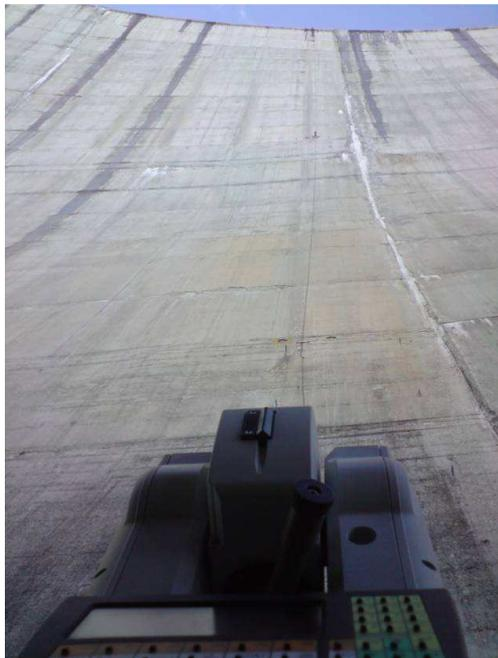
*Figure 14 : Pendule optique par visées verticales, Alpiq*
