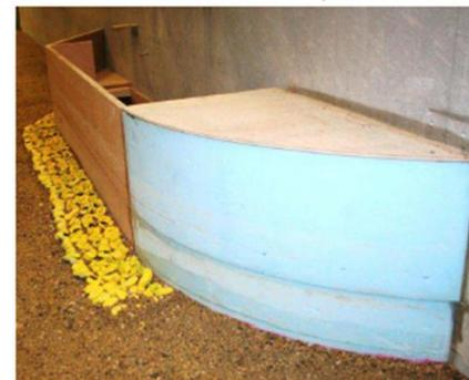
Protection en enrochements artificiels tétrapodes
