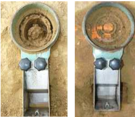
Aspect des talus après les essais d'érosion externe : talus non traité (à gauche) et traité à la chaux (à droite, conditions d'essai plus sévères).
