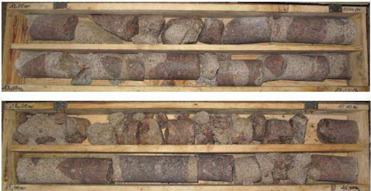
Graphique 3 : Carotte avec un taux de récupération inférieur à 90% (barrage de Pont-et-Massène)
