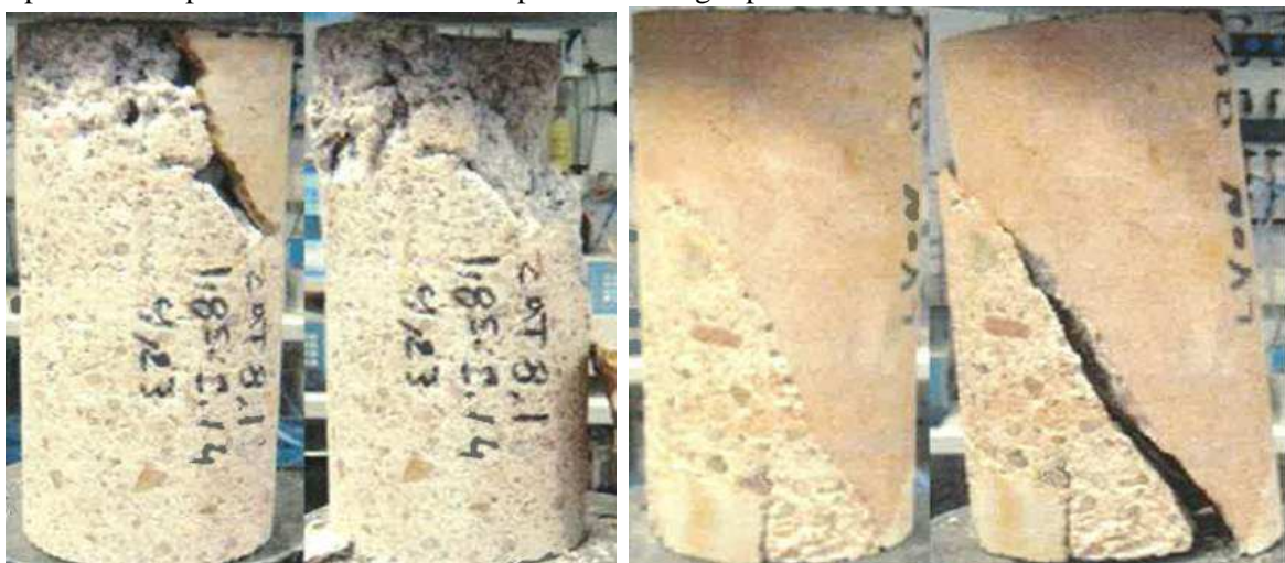
Graphique 6 : Exemple de carottes maçonnées testées (projet aménagement rives de Saône – Défilé)
