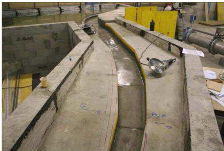
Figure 4: Photographie du modèle réduit de l'évacuateur de crue (construit par le laboratoire de la CNR)
