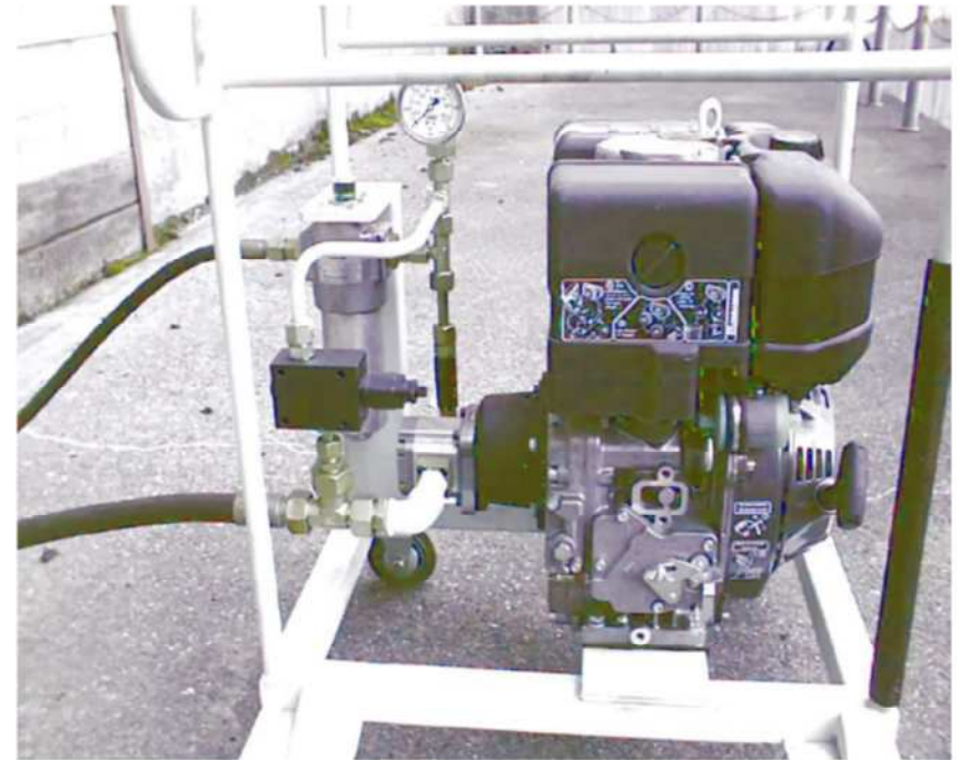
Groupe Thermique motopompe d'ultime secours (Barrage de Roselend)
